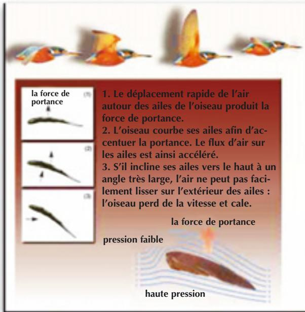
La surface supérieure des ailes des oiseaux est courbée tandis que la partie en dessous est plate. Cette forme produit moins de pression sur le dessus par rapport à la partie en dessous. Cette différence dans la pression d'air produit la force de portance qui permet à l'oiseau de s'élever dans les airs en battant des ailes vers le haut.<sup>187</sup>
