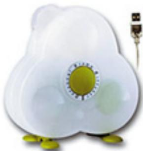
**L'appareil USB-P@d, fabriqué par la firme Duftspezialisten permet aux ordinateurs de dégager des odeurs basées sur les préférences de leurs utilisateurs. Grâce à cet appareil de transmission d'odeurs, un drive peut mettre en place un courant d'air commandé par ordinateur. Ce parfum provient d'une cartouche rechargeable remplie de 20 types d'huiles différentes. Ces parfums contrôlés par ordinateur peuvent aussi fournir des sons et des images appropriés de la nature.**
