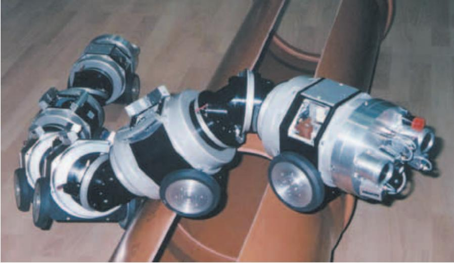
développé par le Ames Research Center de la NASA et appelé le "Snakebot". Ce robot fut conçu afin de pouvoir rester constamment en équilibre sans être déstabilisé par les obstacles.<sup>105</sup>
