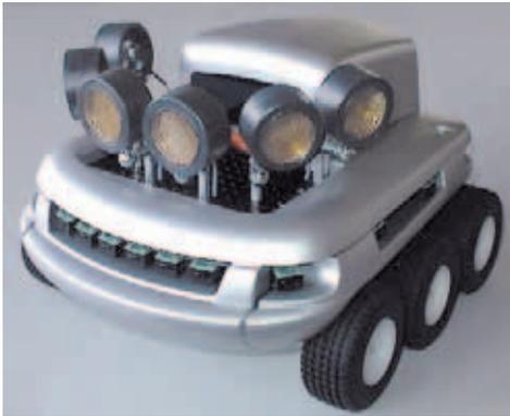
**Les scientifiques et ingénieurs ont construit plusieurs robots à partir de systèmes de sonar naturel. L'un d'entre eux, le robot appelé "koala", construit par la société K-Team, possède six sonars et fut conçu pour des explorations à distance.**
